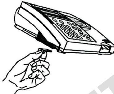
d.- Una vez instalado el Code Chip de supervisor, compruebe que permanezcan dos opciones adicionales de menú en la pantalla.
